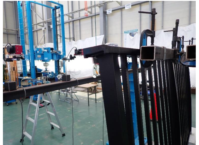
写真5 試験体の状況 最大載荷荷重時
